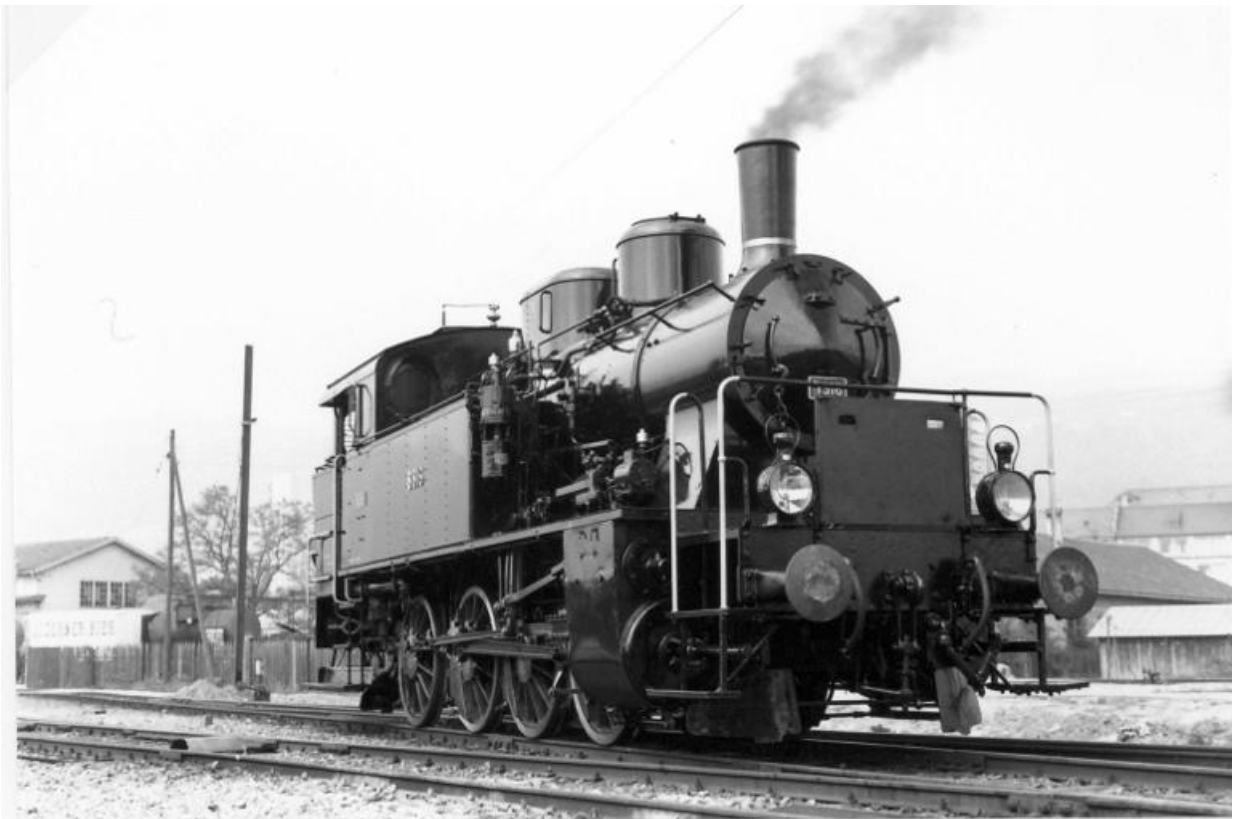
Frisch revidierte E 4/4; deutlich zu sehen: Schutzplatte an der Plattform (Aufnahme in Biel), Art.no.: 2254/6 und 2254/7
