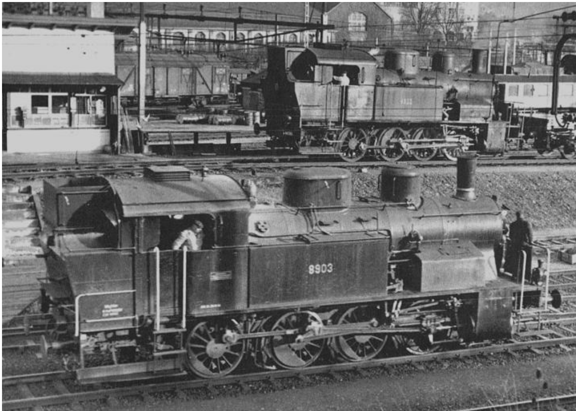
E 4/4 no 8903 am Ablaufberg in Basel, gut zu erkennen sind die gelben Griffstangen und Abdeckung des Dampfzylinders der Umsteuerung (Art.no.: 2254/4). Im Hintergrund die E 4/4 8902
