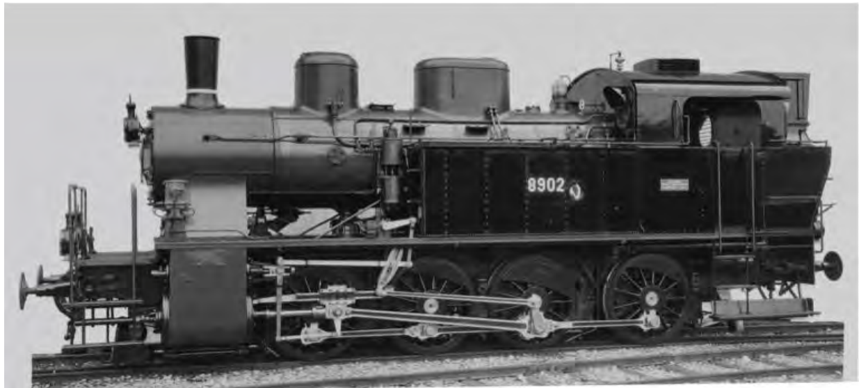
SLM Werkbild von 1930, eine der ersten umgebauten C 4/5 zu einer E 4/4 (Art.no.: 2254/3)
