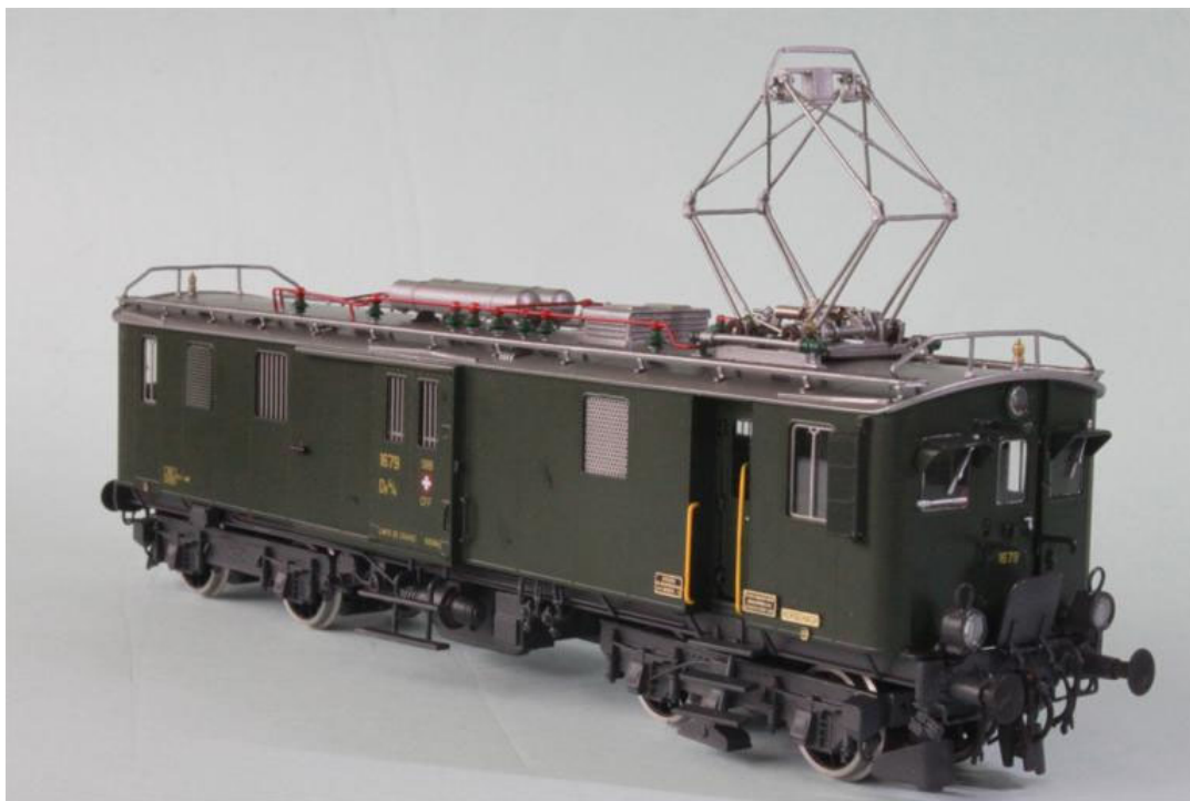
Das nun fertige Modell des SBB/CFF De 4/4 no 1679 "Rorschach" (SBB grün), dieser Triebwagen wurde bereits auf einen Pantografen umgebaut und besitzt die "Hülsenpuffer", Indusi-Zugsicherung, er hat auch die Laternen (ohne Messingring). Es handelt sich dabei bereits um die historische Erhaltungsversion von 1963. Unser Art.no.: 2268/2
