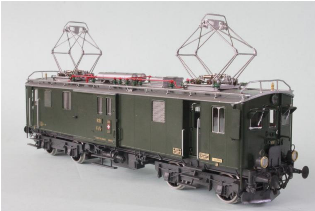
Seite Führerstand 2 des Fe 4/4 no 831 "Le Brassus", natürlich noch mit Stangenpuffer, Tachyantrieb jetzt vorhanden, sehr feine Pantografen, man beachte den durchgehenden Schneeflug. Der grosse Schneeräumer wurde übrigens dem Triebwagen später auf der Strecke "Le Brassus-Puidoux" zum Verhängnis und brachte diesen zur Entgleisung und in extreme Schiefelage, (unsere Art.no.: 2268/6)
