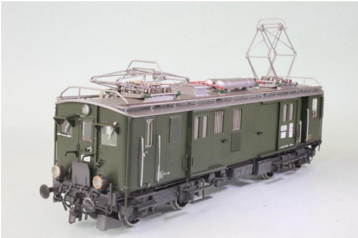
SBB/CFF Fe 4/4 no 18511, prototyp d'origine. avec des plaques en emaille, année 1929, photo cabine II, toutes les portes sont à ouvrer vers exterieur ou interieur (fermeture magnetic), des portes coulissantes compartiment bagages, la machine a encore les anciens tampons et laternes, le compteur tachygraph manque encore sur ces prototypes
