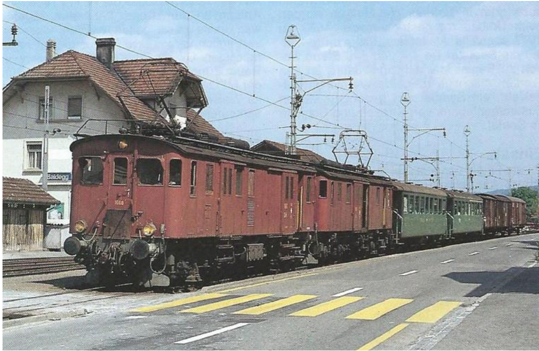
Fe 4/4 (De 4/4 Beschriftung), no 1668 mit 1662, Umbau 1 Pantograf, "Seetaler" hier in Doppeltraktion, ca. 1968 gut zu erkennen; das zusätzliche Fenster links in der Rundung (unsere Art.no.: 2268/5)
