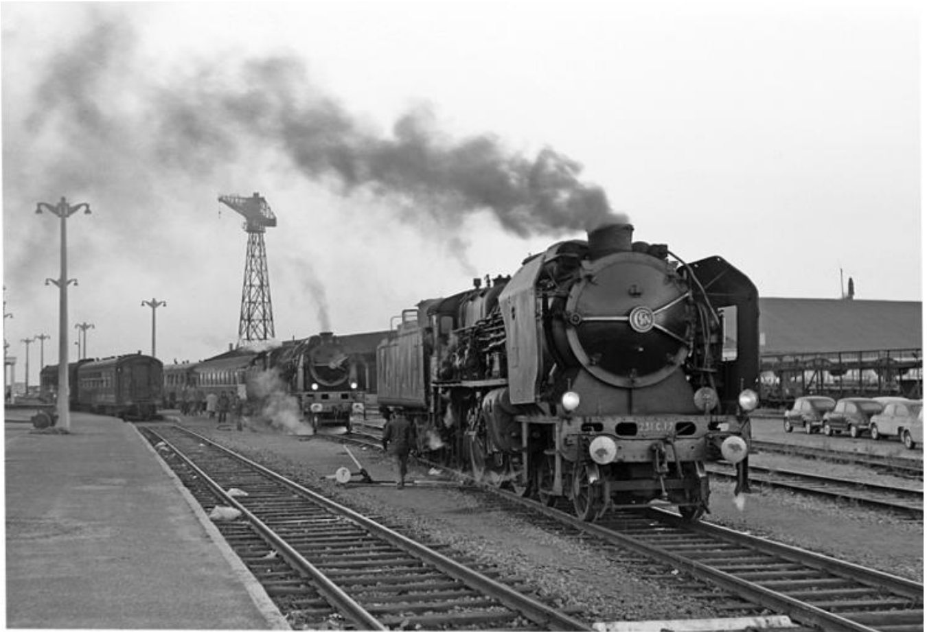
Umspann der Lokomotive SNCF C 17 mit "GROSSEN Windleitblechen" (vermutlich Dunkerque um 1948)
