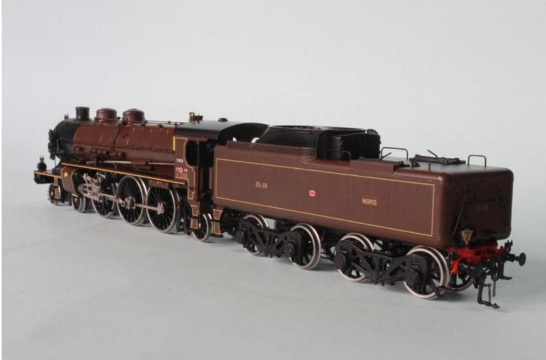
**Original Maschine NORD 231 no 3.1206 "Fives", Tender 37m<sup>3</sup>, (unsere Art.no.: 2269), folgende Korrekturen sind noch im Gange: Fettbüchsen am Kessel links und rechts werden in BRONZE Farbe ausgeführt, Lufttank unter Umlaufblech in SCHWARZ, Diese Maschinen besitzen keine Kesselringe in Bronze oder gelb !**
