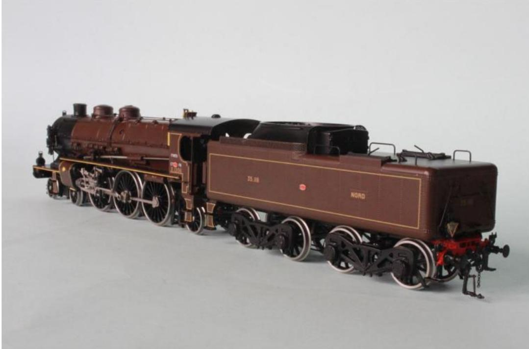
machine d'origine NORD 231 no 3.1206, "Fives" tender 37m<sup>3</sup>, (notre Art.no 2269) corrections: les boites de graissages gauge et droite (8 pces par côté) devront être en BRONZE, réservoir d'air sous le tablier en NOIR. Les machines n'avont pas des cercles en laiton ou jaune !
