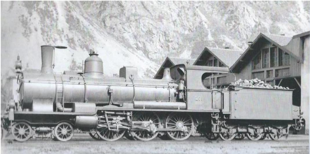
Es gibt sehr wenige Fotos der A 3/5 no 201 mit dreizylinder Triebwerk. Die Maschine unterscheidet sich äusserlich praktisch nicht von der A 3/5 no 202 mit vierzylinder Verbundtriebwerk. Diese Modell haben wir nicht in Produktion.
