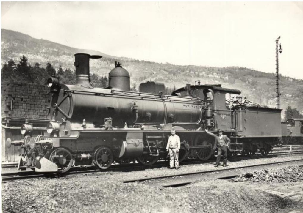
**SBB/CFF A 3/5 no 926, mit Rauchverzehrer System Langer (zwei Ringe am Kamin), gerades Umlaufblech, geänderte Kabine, etc., etc. .... (wie unsere Art.no.: 2278/9)**
