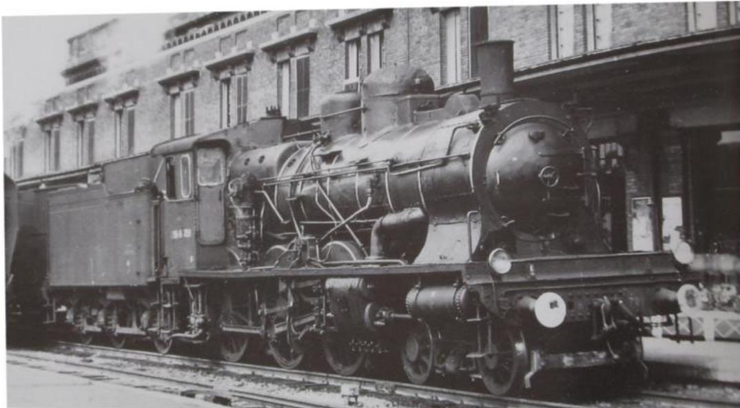
**une 230 B réstituée à la NORD (machines no 729), tender avec rehaussement, éclairage électrique, turbo-dynamo, carenage soupapes; notre Art.no.: 2280/5**
