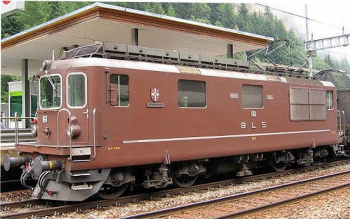
Die Stundenleistung der Maschinen beträgt 4'980 kW, das sind ungefähr 6'720 PS, Geschwindigkeit max 125 km/h, das Dienstgewicht beträgt 80 Tonnen. Die braunen Maschinen mit ihrer typischen Plattform vor dem Führerstand werden leider heute Stück um Stück ausrangiert; ich würde behaupten, dass die BLS noch nie so eine gute und langlebige Allround-Maschine in Ihrem Lokomotiv-Inventar hatte.....
