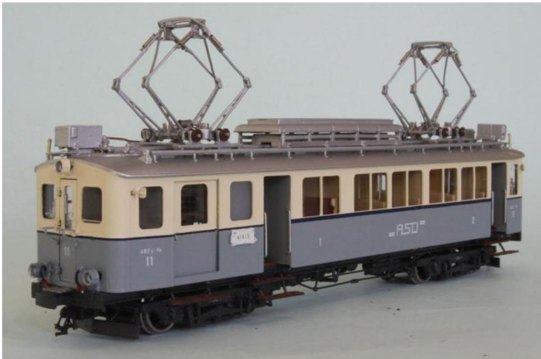
**Triebwagen ABFe 4/4 no 11 neu aufgebaut nach dem Unfall (siehe oben), jetzt mit grosser schiebbarer Frachtüre, die Frontfenster am Führerstand no 1 sind auch etwas moderner geworden (abgerundet und eingesetzt). Aussenrückspiegel wurden als zusätzliche Sicherheit montiert.... (set no 10)**
