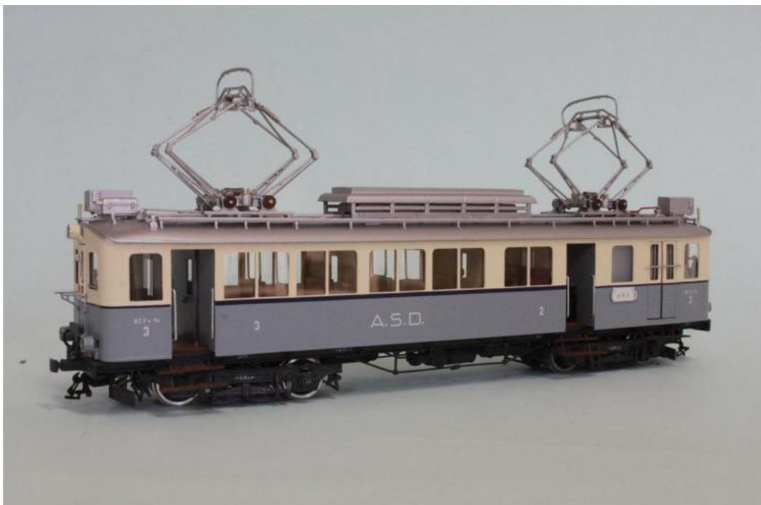
**Triebwagen BCFe 4/4 no 3 (Wagen aus Set no. 7), Der Triebwagen besitzt noch den alten Lyra-Pantografen und ist wie die Ursprungsauführung, ca. 1945**
