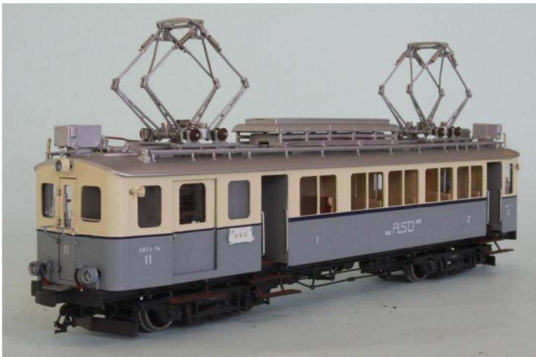
Voiture ASD ABFe 4/4 no 11 après sa reconstruction après l'accident en 1975 (voir en haut); maintenant avec des grandes portes de bagages. La cabine no 1 est aussi une reconstruction avec les fenêtres modernes et arrondis. Maintenant, pour une certaine sécurité, avec des rétroviseurs extérieurs. .... (set no 10)
