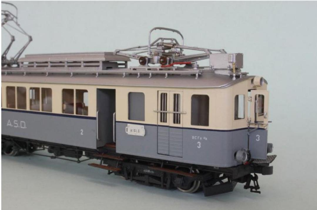
Ce type de voiture n'a pas des portes laterales, seulement le couloir traversant. Les portes du compartiment bagages sont en style ancienne..... La porte avant est aussi a ouvrir et donne la vue pour la cabine de conduit.....
