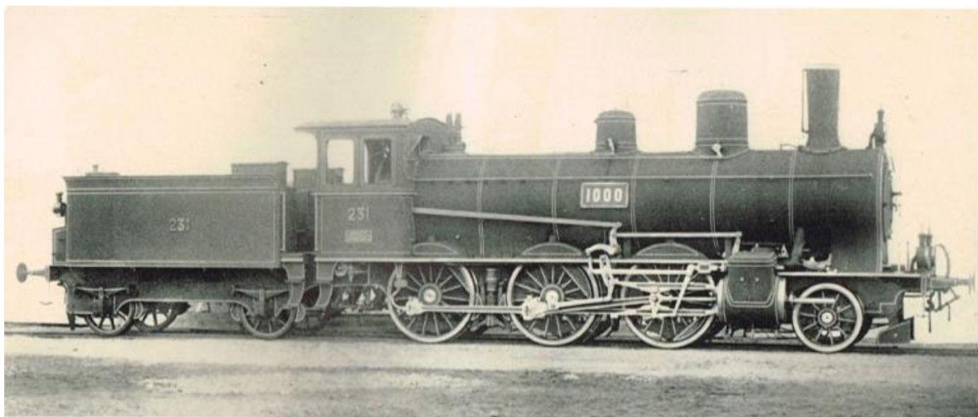
Jura-Simplon A 3T noch mit der Ursprungsnummer 231 und dem 2-Achs-Tender, der dann auf 3-achsig umgebaut wurde. Bei Ablieferung erhielt die Lok die no 301 und war zugleich die "tausendste" Lok von SLM, JS-Farbe grün mit Zierlinien.
