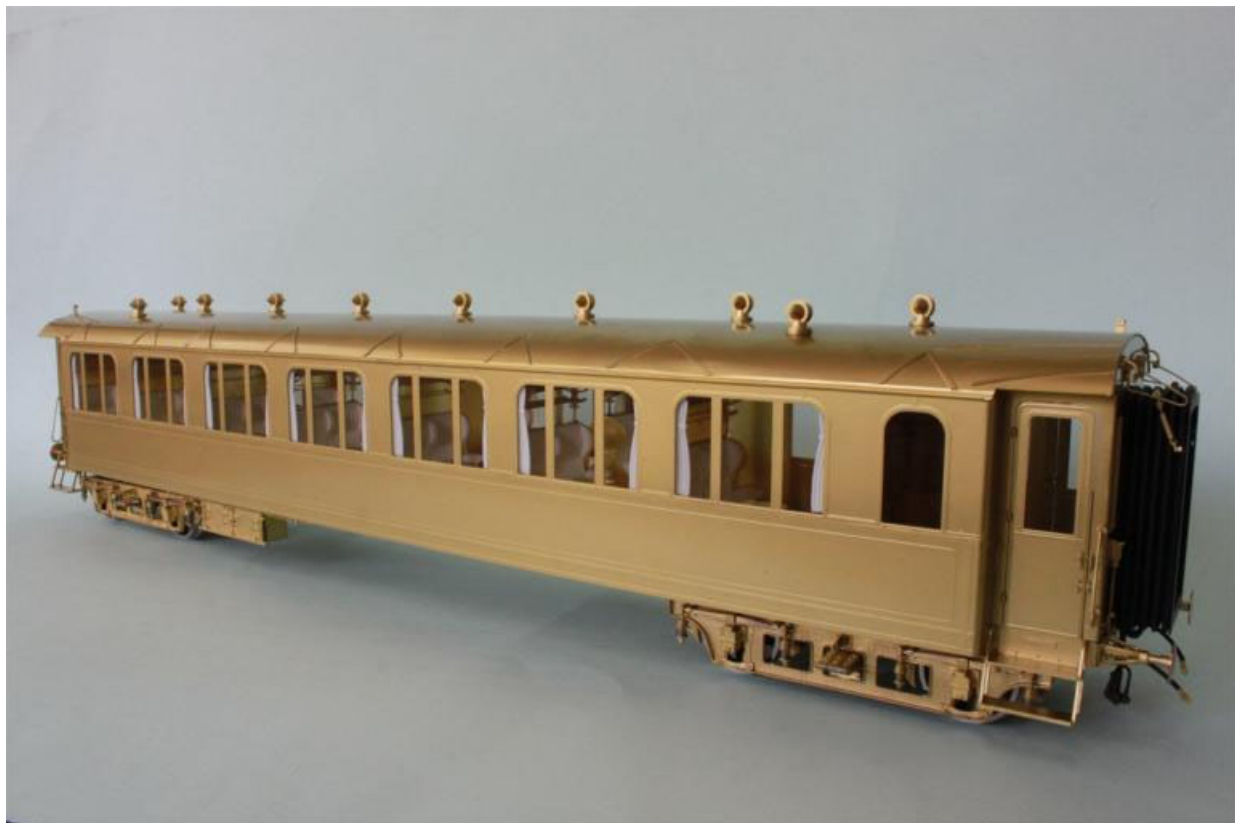
Wagenkasten (Grundbasis) 1 Klasse A4, im Aufbau
