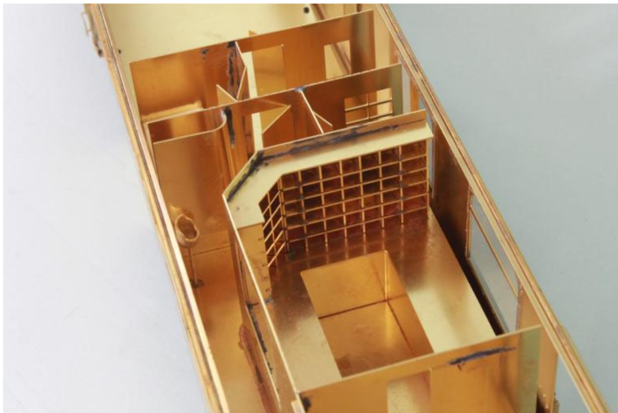
Innenausbau des Postwagens (noch im Aufbau)
