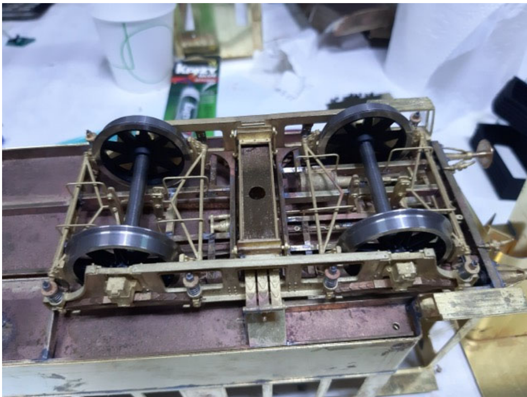
Die Drehgestelle der GB besaßen jeweils den integrierten Wd-Bremszylinder der Unterteil des war parktisch nur mit den 4 Kant-Stahlträger, den Traversen und den Batterie-Kasten (für die Beleuchtung) bestückt. Bei den Nachfolge-Versionen wurde die Beleuchtung mittels Gas ausgeführt (Gastanks unter dem Wagenboden)
