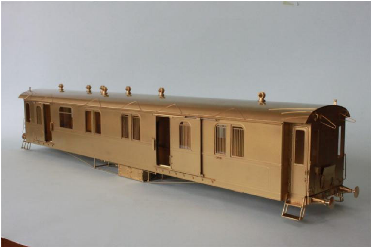
Gepäckwagen im Aufbau (noch ohne Drehgestelle und Briefkasten)
